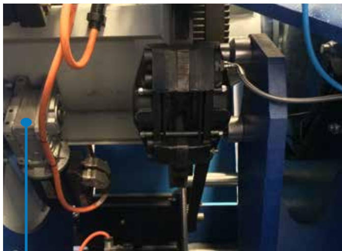
Freni idraulici per ciclo di orditura Hydraulic brakes for warping cycle
