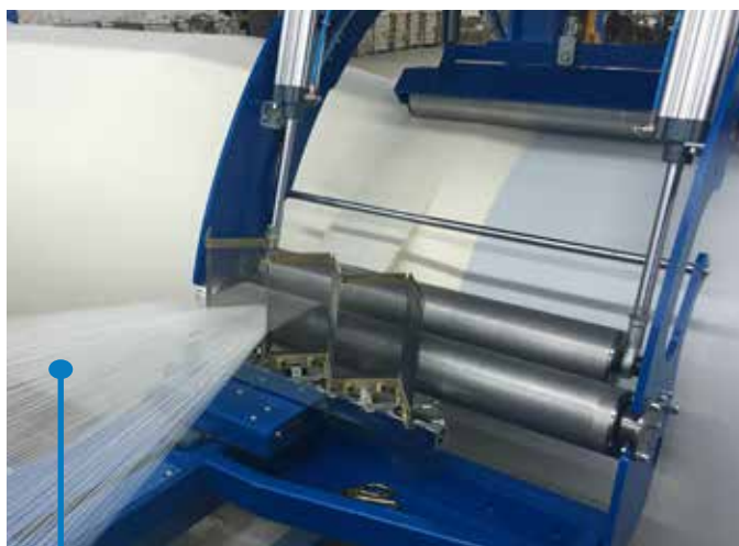
Posizione innovativa per il rullo compattatore Innovative position for compactor roller
