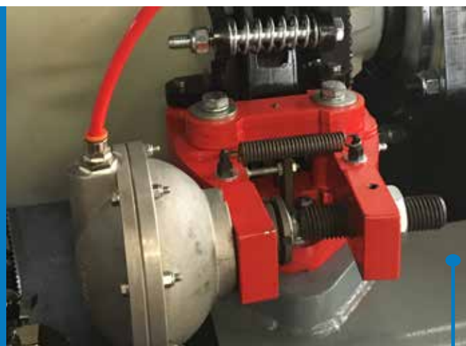
Freni pneumatici per ciclo di insubbiatura Pneumatic brakes for beaming cycle
